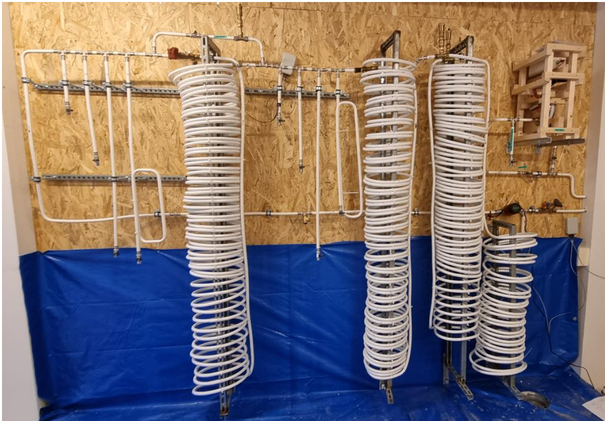
Figur 2: Riggen 1.0 (åtgärdssidan) i Göteborg. På baksidan fanns en likvärdig uppbyggnad. Efter riggen flyttades från Göteborg till Lund genomfördes lite förbättringar och några ventiler byttes ut och lades till. Varmvattenberedarna som fanns i riggen 1.0 syns ej på bild.
