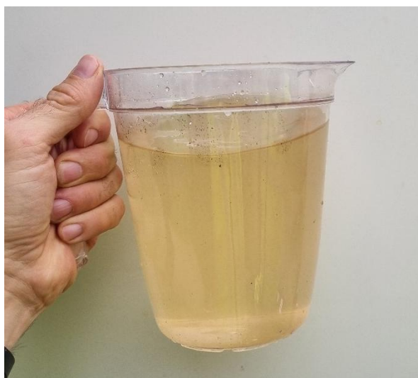
Figur 10: Foto på vatten från Riggens åtgärdssida efter ett par dagar med hypoklorsyra.
