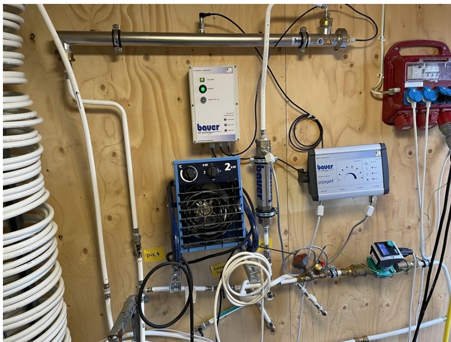
Figur 13: Foto på utrustning från Bauer monterad i riggen. På fotot syns både UV-aggregat och själva AMF-aggregatet.
