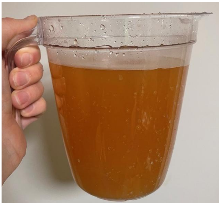
Figur 18: Tappvatten från ett provtillfälle på åtgärdssidan vid sanering med väteperoxid.
